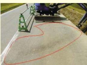
バックホーの作動油のホースが破裂して、舗装の上に漏れている。
