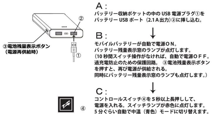
電源の消し方 コントロールスイッチ④を5秒以上長押しして、スイッチランプが消灯し、電源を切る事ができます。
